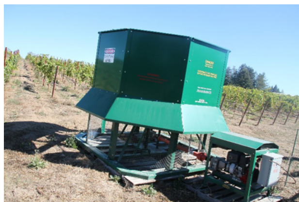
Figure 23. Dispositif « selective inverted sink ». Winery DE LOACH dans la Russian River en Californie.
