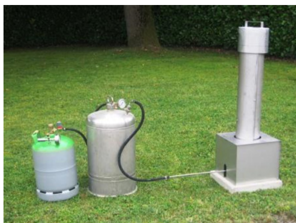
Figure 8. Diffuseur d'Iodure d'Argent (Source ANELFA).
