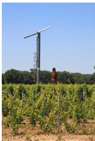
Figure 19. Brasseur d'air avec chauffage, région de Chinon en Val de Loire.
