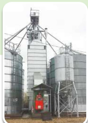
Le brûleur ecoHORNET AHP600 a remplacé l'injecteur diesel par un générateur d'air chaud servant un séchoir à grains (Targul Jiu, Gorj)
