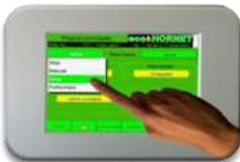
Les derniers équipements sont basés sur l'automatisation complète et sont produits par SIGMATEC GmbH CO KG ; ils contrôlent complètement la génération de la chaleur et tous les composants du système. L'écran tactile en couleurs fournira des informations complètes sur le fonctionnement de l'équipement.
