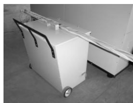
Bac récupération des cendres.
