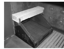
Auge du bruleur acier, fonte et brique réfractaire
